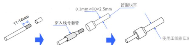
图 6 线缆制作示意图
